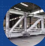
Roof steel truss fabrication 天面工字鋼桁架
